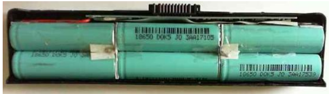
Une batterie d'ordinateur portable 6 éléments (mise en série de 3 paquets de 2 en // )
