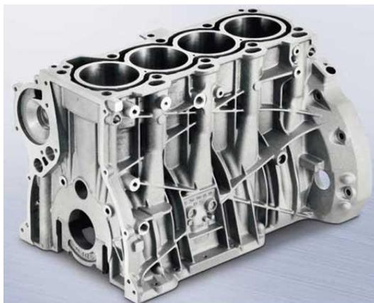
*Bloc moteur d'un moteur L4*
